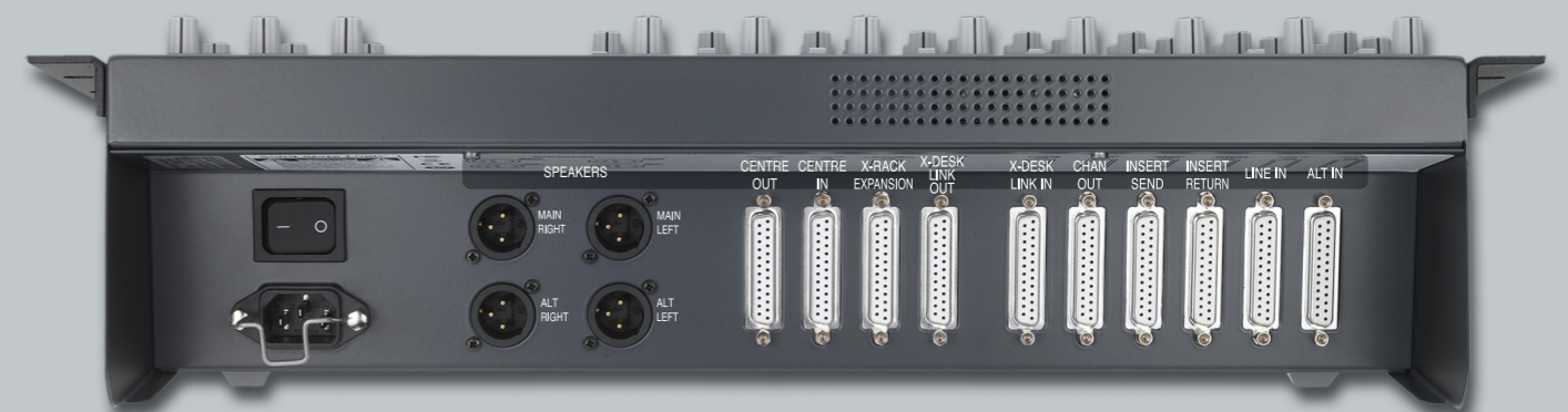
X-Deskリアコネクタパネル面。この写真はラックマウント用のアングルが取り付けられている状態の写真です。
