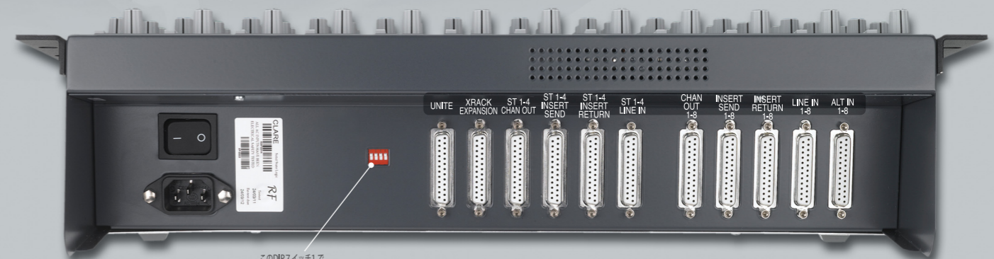
このDIPスイッチ1でオーバーロード表示の値を設定できます。off: +18dBu on: +24dBu X-Pandaリアコネクターパネル面。この写真はラックマウント用のアングルが取り付けられている状態の写真です。
