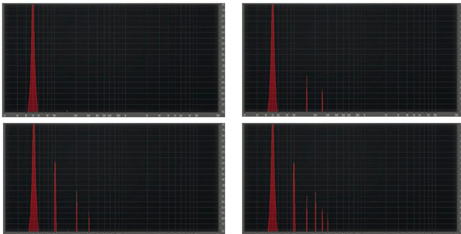
Die Abbildungen 1 bis 4 illustrieren die unterschiedliche Obertonstruktur der vier schaltbaren Betriebszustände: 1 = Low THD on, 2 = all off, 3 = 4K on plus Low THD on, 4 = 4K on
