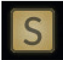
Solo Clear ボタンは、SSL 12 Mixer のアクティブなソロ (または AFL) をすばやくクリアするためのものです。いずれかのチャンネルが **SOLO** または **AFL** になると、Solo Clear ボタンは黄色に点灯します。
